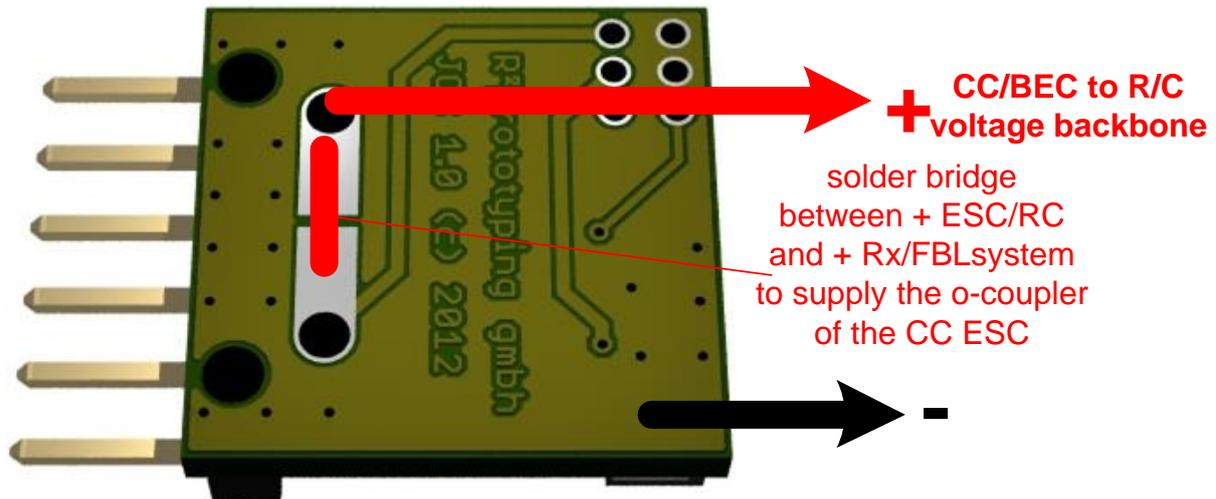
Hat der Castle Creations Regler kein BEC, dann wird er einen Optokoppler am Gasanschluss haben. Der Koppler braucht Betriebsspannung, die nicht der Regler zur Verfügung stellt. In diesem Falle setzen Sie eine Lötbrücke wie oben eingezeichnet (solder bridge). Das verbindet „+“, die rote Ader des Servokabels am Regler, mit „+“ Ihrer R/C-Spannung im Modell. Diese R/C-Spannung kommt über das Gas-Servokabel vom Empfänger oder FBL-System.
